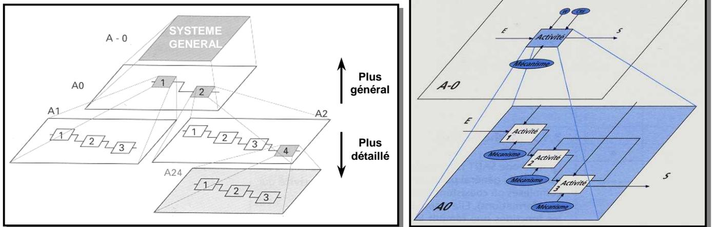
La méthode SADT (System Analysis Design Technic) permet de passer d'une vision globale du système à une vision de plus en plus précise. Chacune de ces fonctions est représentée par un actigramme (ci-dessous) précisant l'action qui modifie une matière d'œuvre en lui apportant une valeur ajoutée. Chacun de ces actigrammes s'articule en cinq parties :
